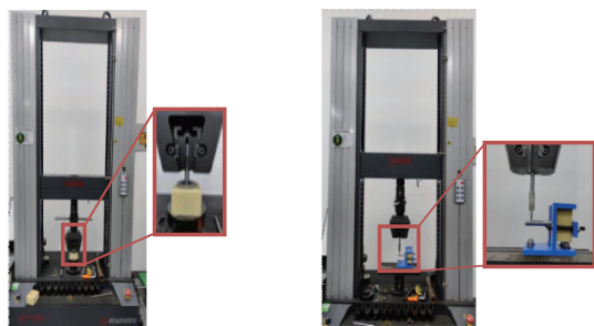
(a) 把髌臼杯压入聚氨酯块 (b) 把髌臼杯从聚氨酯块中撬出
