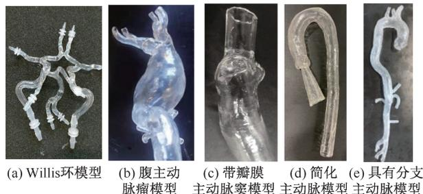
图6 喷涂法和旋涂方法制作的模型
