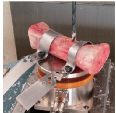
图 2 骨骼钻削实验装置
