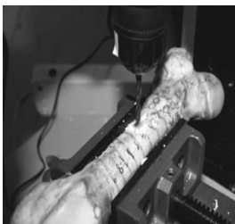
图3 测试采集新鲜猪股骨干钻削进给力工作图
