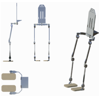
图9 外骨骼总体设计 Fig. 9 Final exoskeleton design
