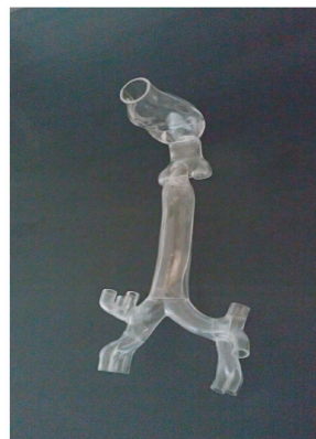
图 1 真实人体上呼吸道实验模型
