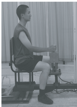
图 3 肘部弯曲 120^\circ 的推力测量
