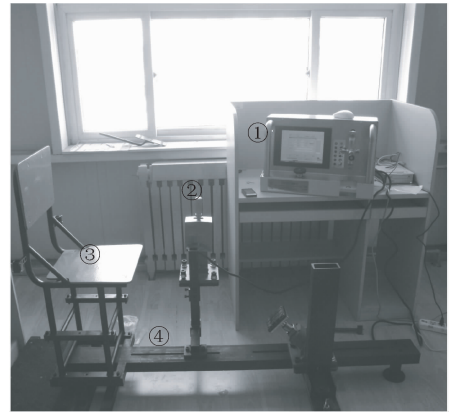
图 1 肢体力综合测量仪(①-主机,②-手柄,③-座椅,④-支架)
