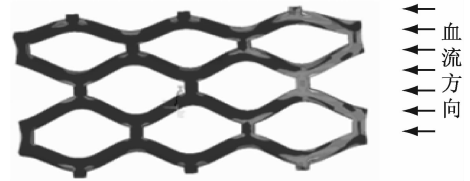
图4 支架的 Von Mises 应力分布 Fig.4 Distribution of Von Mises stress on the stent
