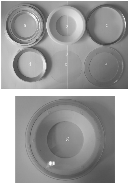
图2 弹性底细胞培养皿 (a - 下压圈, b - 聚四氟乙烯预紧压圈, c - 锁紧螺圈, d - 上压圈, e - 弹性硅橡胶膜, f - 有机玻璃透明培养皿盖, g - 组装完成的培养皿)
