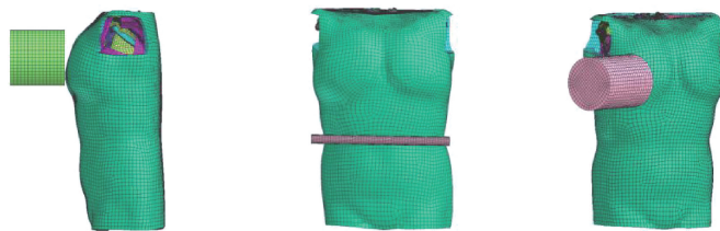
(a) 胸部正面撞锤冲击实验 (b) 腹部正面棒击实验 (c) 胸腹部侧面撞锤冲击实验
