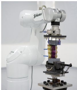
图4 脊柱 L2~5 节段模型安装机械臂测试图
