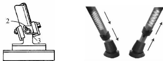
(a) 基于扭簧机构的拐杖脚 (b) Millennial Crutch 拐杖脚
