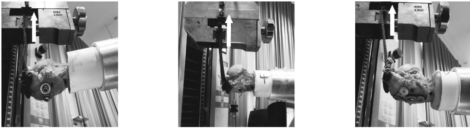
图3 生物力学测试(白色箭头表示0°外展位的加载点的方向)
