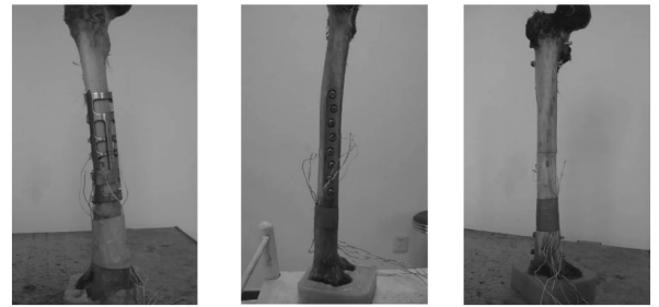
(a) 环抱器固定 (b) 加压钢板固定 (c) 髓内钉固定
